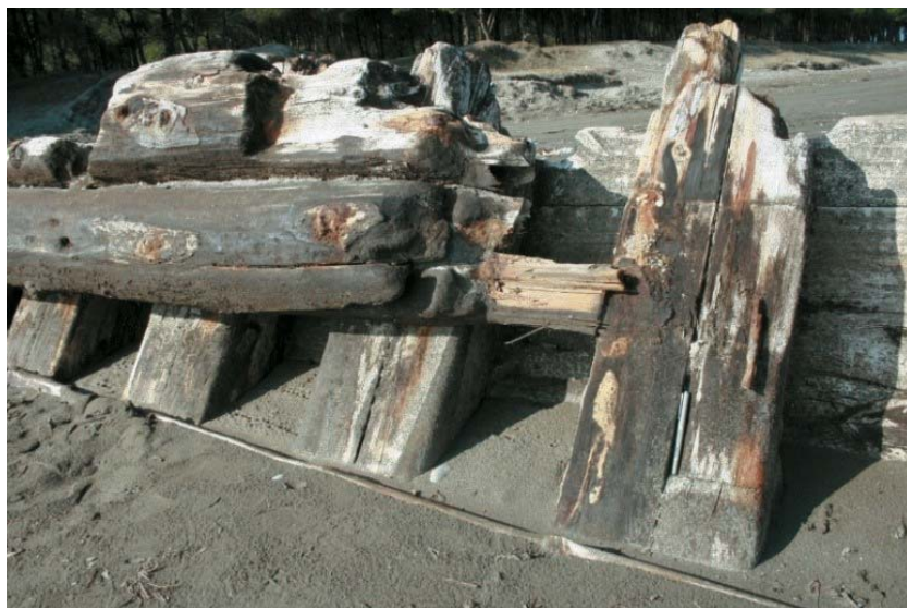
تصویر شماره ۷: اجزاء تشکیل دهنده بدنه کشتی تاریخی تالش با عایق قیر جهت ضد آب کردن کشتی.
