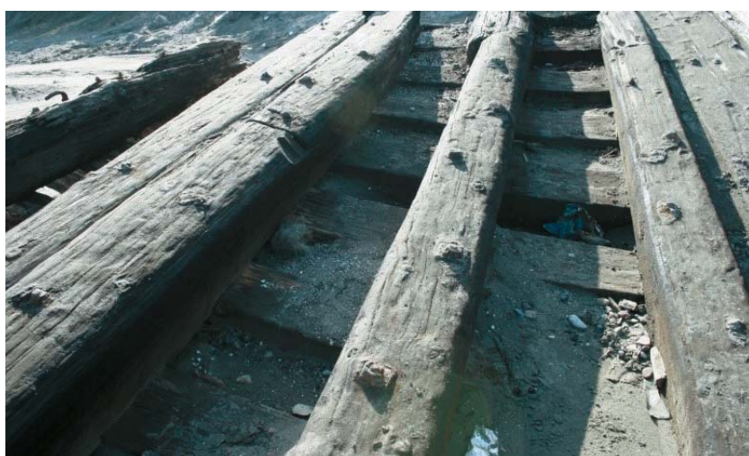
تصویر شماره ۸: الوار حجیم چوب بکار رفته در اسکلت کف کشتی تاریخی تالش.
